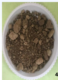
现场堆料耕植土
